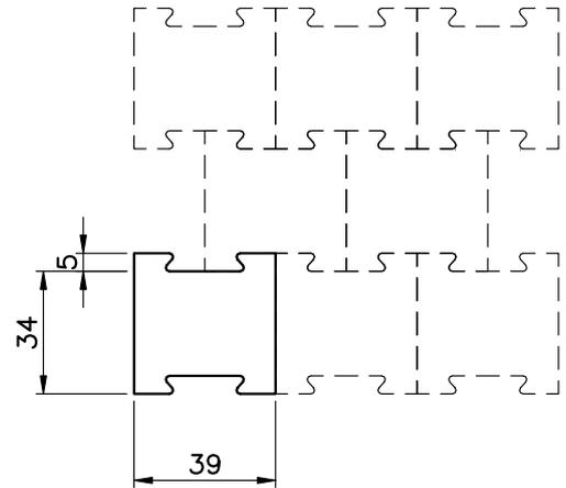
**Weiche Verbundplatte für mittlere mechanische Beanspruchung – rutschfest – gut isolierend – schalldämmend – leicht zu reinigen – leicht zu verlegen – partiell austauschbar.**
